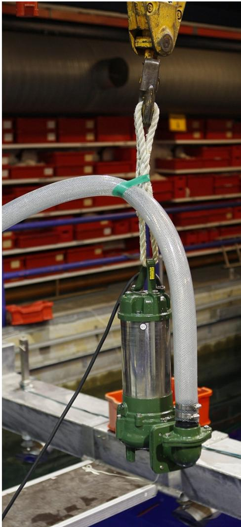
Volumet i duken ble målt ved å pumpe ut vannet gjennom en vannmåler.
